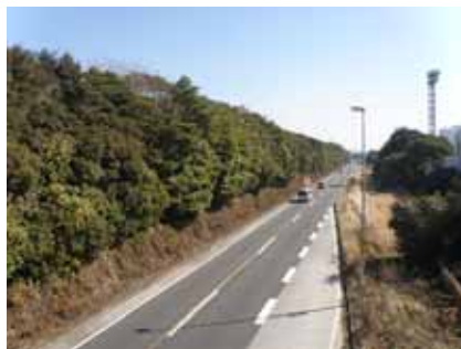
事例-3：国道357号・東関東自動車道 。共同福利施設として整備された緩衝緑地帯。車道側に築堤し遮音壁が設置されている（千葉県習志野市香澄）
